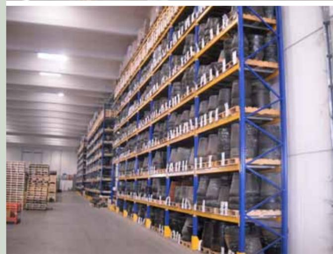
Scaffalatura pesante realizzata per lo stoccaggio di unità di carico pallettizzate di ogni dimensione.
